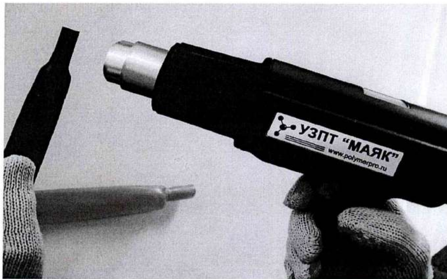
Рисунок 1 – Процесс термоусадки ТУТ
