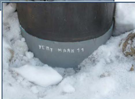
В 2011-2014 гг. ОАО «Фундаментпроект» и ООО «ГАЗПРОМ ВНИИГАЗ» провели лабораторные и натурные полевые испытания на месторождении Медвежье (ООО «Газпром добыча Надым», ЯНАО) свай СМОТ с применением противопучинного покрытия ОСПТ «Reline».
